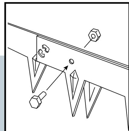
Optimal können Sie die überlappenden Rasenkanten mit einer Schraube und Mutter sichern (benutzen Sie ausschließlich Schrauben und Muttern aus dem gleichen Material wie die Rasenkante). Bohren Sie hierzu ein Loch durch beide Rasenkanten. Um Korrosion zu vermeiden, besprühen Sie die Löcher mit klarem Grundierungslack.
