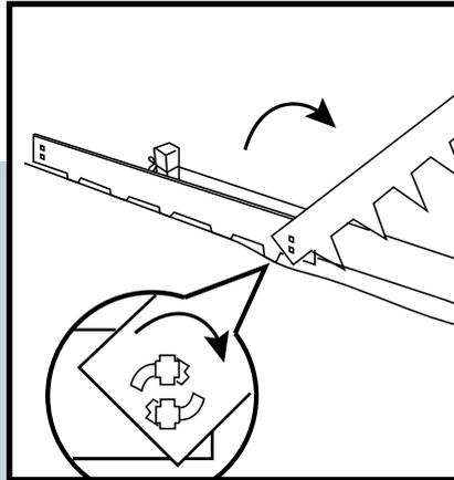
Stecken Sie die erste Rasenkante lose in den Boden und verbinden die Einzelteile miteinander.
