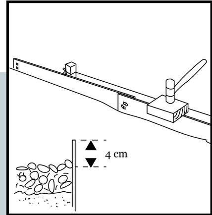
Klopfen Sie die Rasenkante mit Hilfe eines Holzblockes auf die gewünschte Höhe. Beachten Sie bitte das eine Mindesthöhe von 4 cm notwendig ist um eine optimale Stabilität zu gewährleisten.
